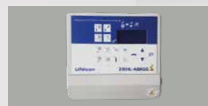
Der temperaturgesteuerte Regler ist robust und einfach in der Bedienung. Dieser passt automatisch die Ventilatorleistung an die gemessene Temperatur an.
